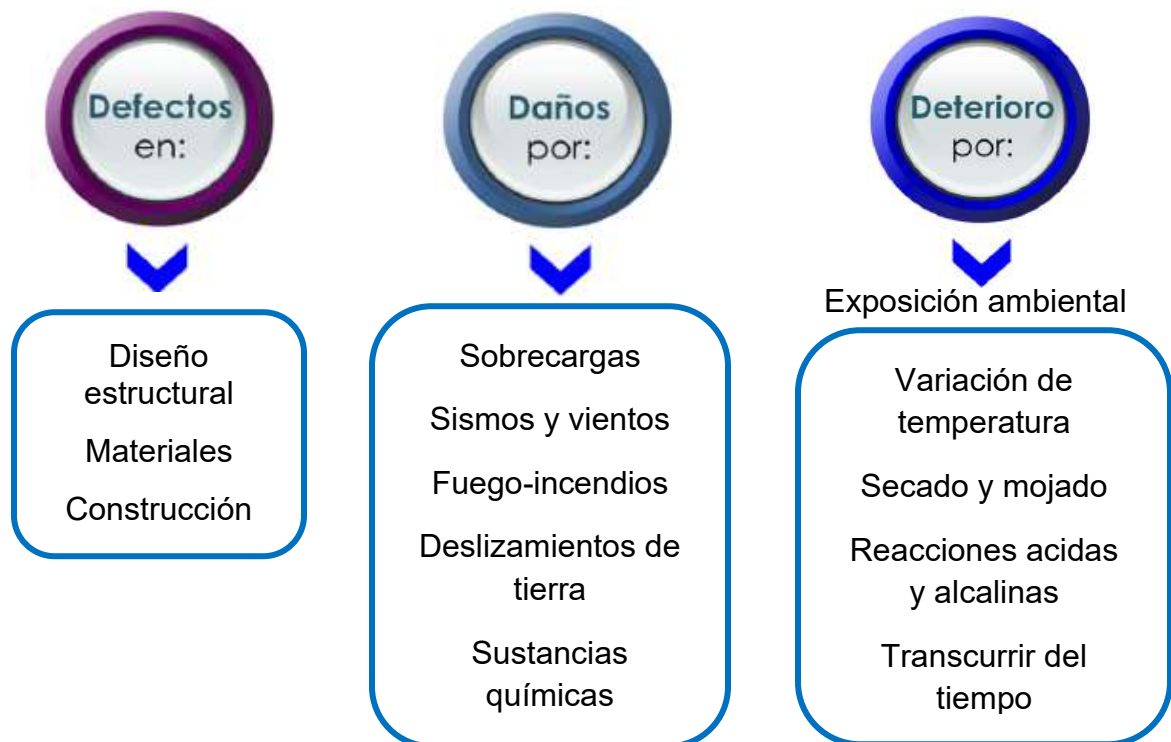
Figura 2. Clasificación general de patologías en edificaciones
