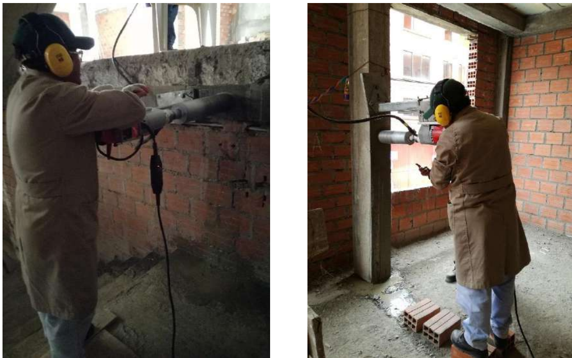
Figura 12. Fotografías del ensayo de extracción de núcleos
